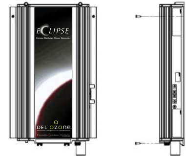
Figura 1 Montaje de pared
